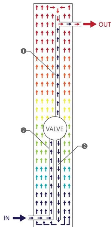
L'eau froide entre via le connecteur IN et remonte au mitigeur entrée eau froide via le tube 1 et entre dans le corps de douche via le tube 2 et est réchauffé par le soleil. En chauffant, l'eau froide remonte en partie supé-
